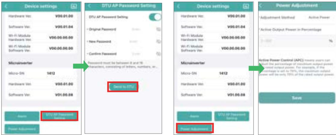
**Hinweis:** Jeder Mikro-Wechselrichter wurde ursprünglich mit einem eindeutigen AP-Passwort ausgestattet, das auf einem nicht abnehmbaren Etikett auf der rechten Seite der silbernen Abdeckung des Mikro-Wechselrichters aufgedruckt ist. Nach Erhalt des Mikro-Wechselrichters empfiehlt Hoymiles, das ursprüngliche AP-Passwort anhand der angegebenen Schritte zu ändern.
