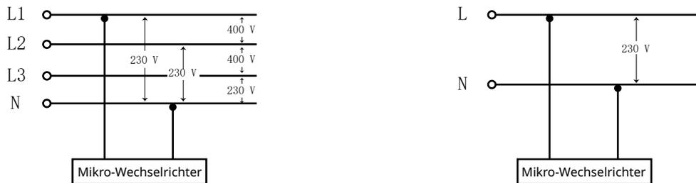
Abbildung 1-6 Unterstützte Netztypen
