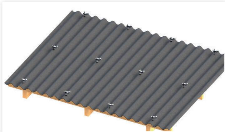
Achten Sie bei der Montage darauf, dass die Stockschrauben / Solarbefestiger gerade und mittig auf einem Wellenberg montiert werden.
