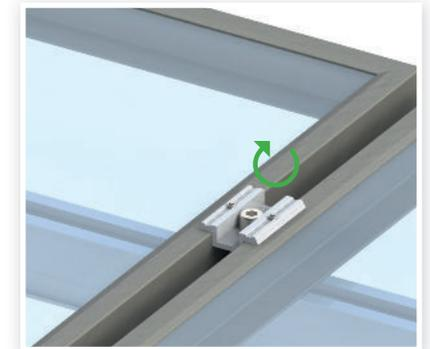
Das jeweils letzte Modul einer Modulreihe mit Abschlussklemmen, wie bereits beschrieben, montieren. Montage der verbleibenden Modulreihen analog.
