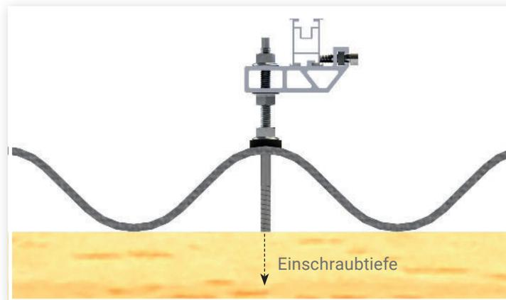
Stellen Sie die Schnellmontageadapter so ein, dass eine **gerade und spannungsfreie** Montage der Trägerprofile möglich ist.
